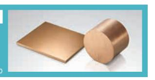
C5191は銅(Cu)残、すず(Sn)5.5~7.0%、りん(P)0.03~0.35%が含まれ、3つを足して99.50%以上のものをいいます。りん青銅は、1~3種まであり、機械的な強さが大きく、耐疲労性、耐食性、耐磨耗性に優れ、鉄鋼のような磁性がありません。ねじ、軸受、ボルト、コネクタなどに使われております。
